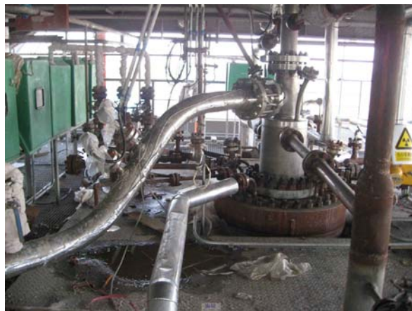
图 5-53 德士古气化炉
