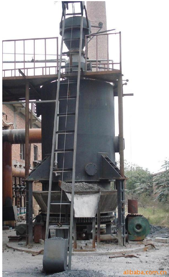
图 5-14 煤气发生炉示意图
