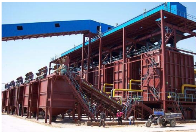
图 2-8 SJ 炉（一种改进型的鲁奇三段炉）实物图
