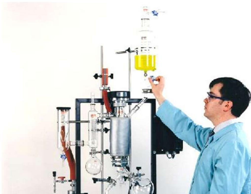
常规蒸馏，通常是指将液相加热至沸腾后再将气相冷凝，从而实现混合物的分离，其实质是利用了不同物质间的沸点差来完成的。尽管这种手段在工业上普遍应用，但对于许多热敏性物系而言，这种方法并不适用。原因在于热敏性物质在沸腾过程中会出现热分解，而这种热分解的速度又是随着温度的升高呈指数升高，随停留时间的增大呈线性增大的。因此，要解决好热敏性物系的分离问题，首先就必须从降低蒸发过程的分离温度和缩短物料的受热时间开始。料的沸点依赖于操作压力，为此，人们开发
