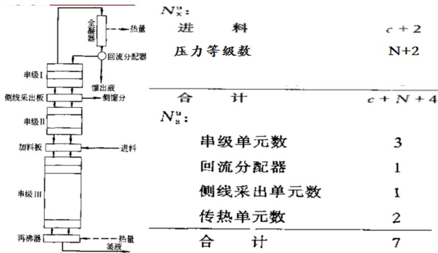
将确定设备设计变量的方法用于有侧线采出的精馏塔分析（如图）。
