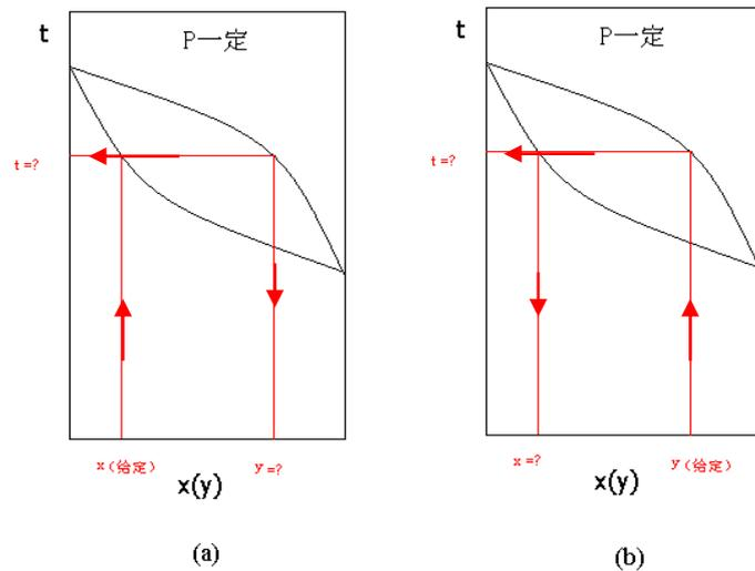
图2.1 泡点和露点示意图
