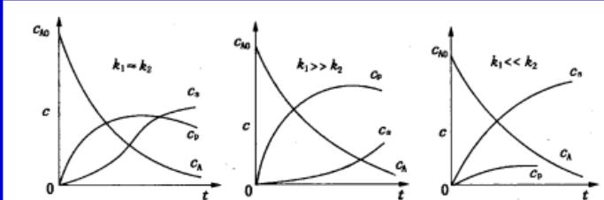
图 2-18 连串反应  $A \rightarrow P \rightarrow S$  的浓度-时间变化示意图
