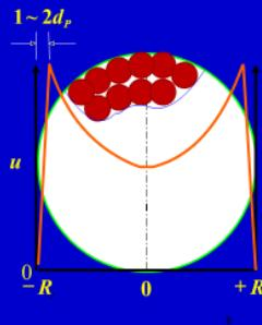
✓真实床层径向空隙率分布是不均匀的，在距壁面约1~2倍粒径处，空隙率最大—沿壁效应。
