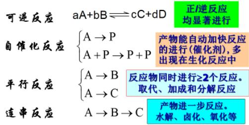
复合反应中组分生成速率的求取: 组分I的生成速率等于其在各个反应中的生成速率的代数和:
