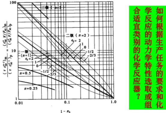
图 2-2  $n$  级反应在简单反应器中性能比较
