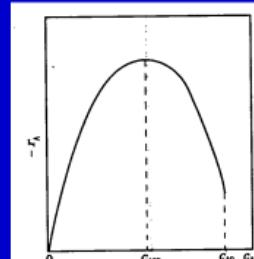
图 2-9 自催化反应的反应速度  $r_A$  与  $c_A$  关系
