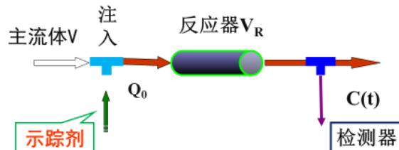
**实验方法：**用极短的时间，在定常态操作的系统入加入一定量的示踪剂，同时在系统的出口处检测示踪剂浓度的变化。取样可以连续跟踪进行，也可以隔一段时间取一次，前者是连续型，后者为离散型。
