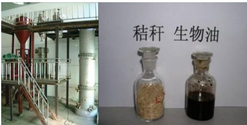
图 4-4 生物质热解液化产品
