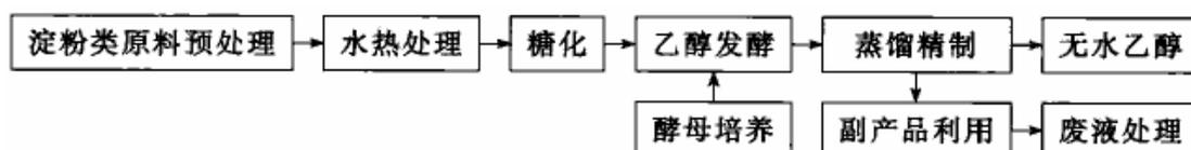
图 7-5 淀粉类生物质原料乙醇发酵工艺过程
