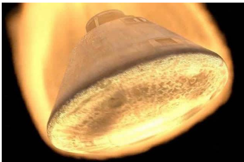
图 1.10 宇宙飞船返回舱的隔热盾
