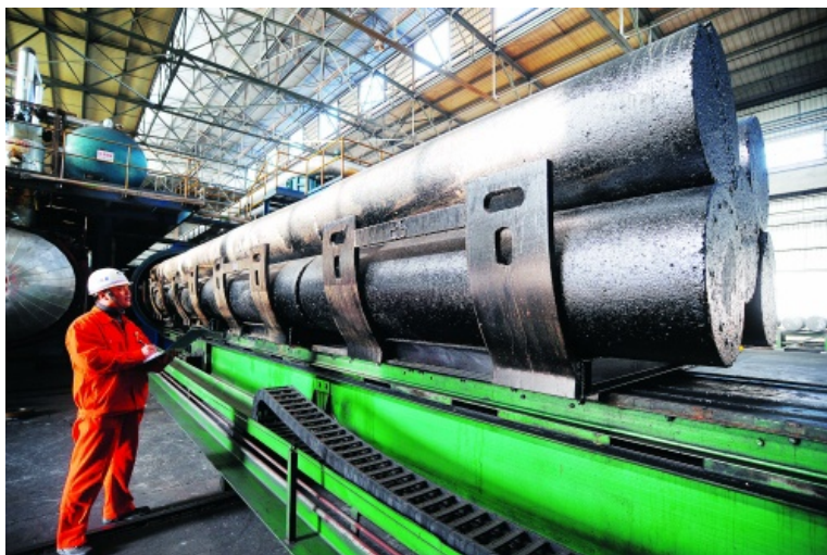
图 7.7 石墨电极的浸渍
