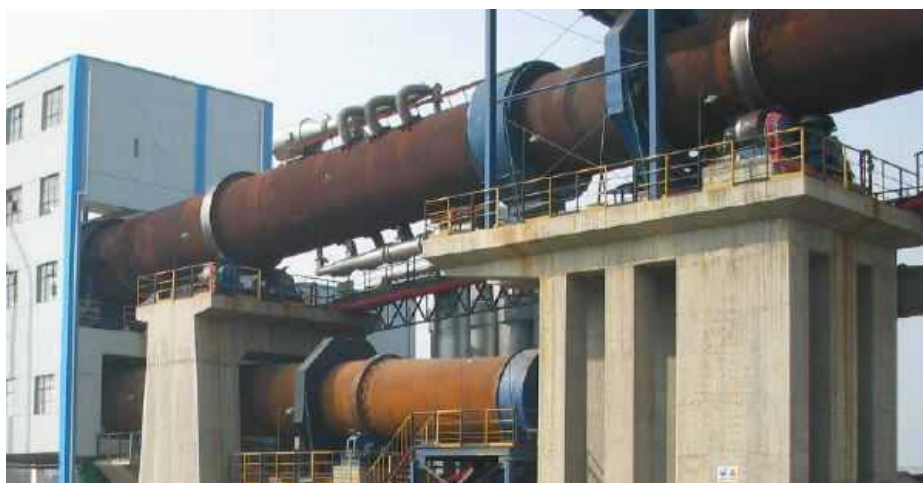
图 7.4 回转窑煅烧
