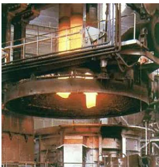
图 1.1 炼钢炉的石墨电极
