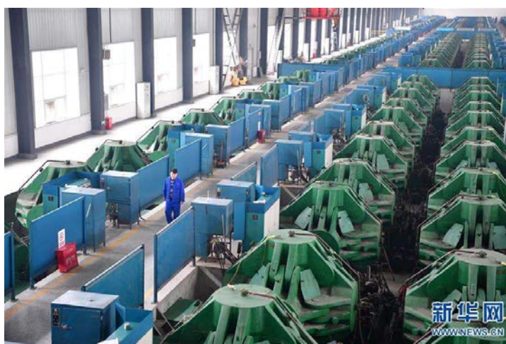
图 10.3 六面顶压机生产人造金刚石
